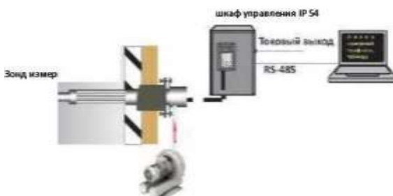
Схема установки Пылемера "ЭКОМЕР" на газоходе
