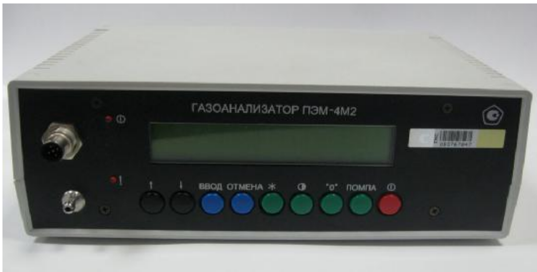
Рисунок 2 – Газоанализатор ПЭМ-4М исполнения ПЭМ-4М2, внешний вид
